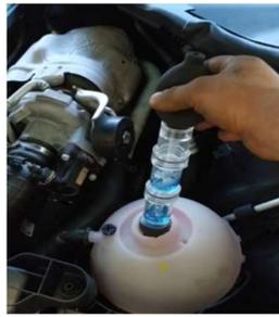
El detector de fugas **STE** es un dispositivo de prueba para la detección temprana y fiable de fugas entre la cámara de combustión y el sistema de refrigeración.
